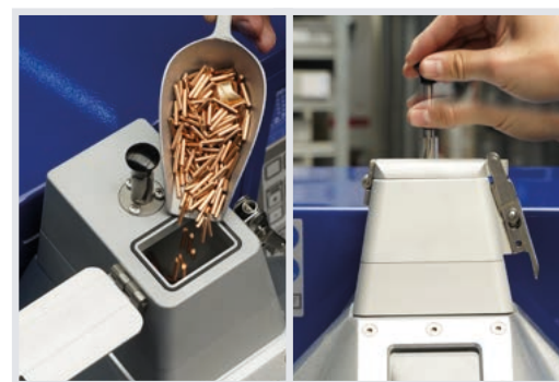
Das Vakuum-Befüllsystem erlaubt das Nachchargieren von Material ohne Sauerstoffkontakt und ohne Verlust von Vakuum
