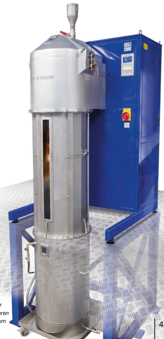
Mit dem optionalen Flake-Kit können statt Granalien auch dünne Flakes produziert werden.
