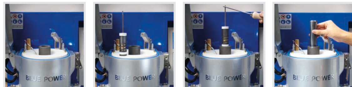
Die einzelnen Ringlagen werden zum Sintern auf einer Spindel zentriert. Damit mehrere Ringe gleichzeitig gesintert werden können, werden sie durch Grafit-scheiben voneinander getrennt.
