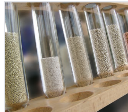
Microgranulat in verschiedenen Legierungen in Korngrößen zwischen 0.1 und 1 mm.
