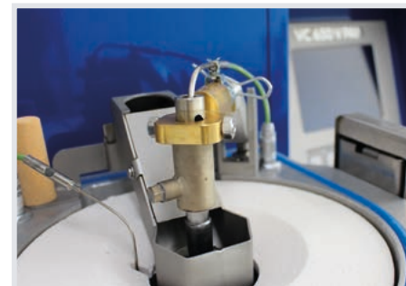
Autom. Verschluss-Stab, Dual-Temperaturmessung
