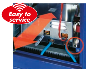
Wartungsfreundliche Einschubtechnik: nur zwei Schrauben müssen gelöst werden, um den Generator zu tauschen
