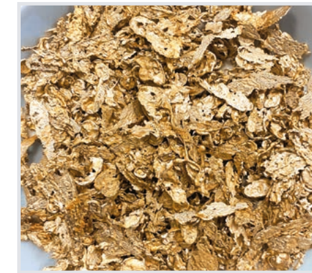
Mit dem optionalen Flake-Kit können statt Granalien auch dünne Flakes produziert werden.
