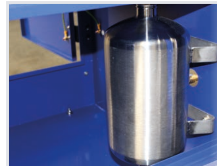
Ein zusätzlicher, in die Anlage integrierter Druckbehälter ermöglicht einen noch schnelleren Druckaufbau und die Turbo Pressure PLUS Funktion.
