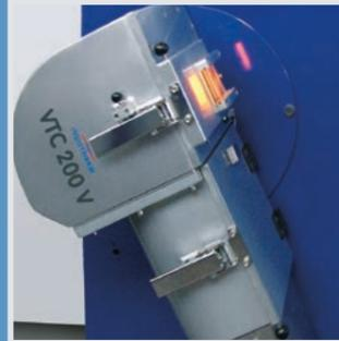
Das Gießen erfolgt durch Schwenken der gesamten Schmelz-/Gießeinheit mittels Motorantrieb um 90°.
